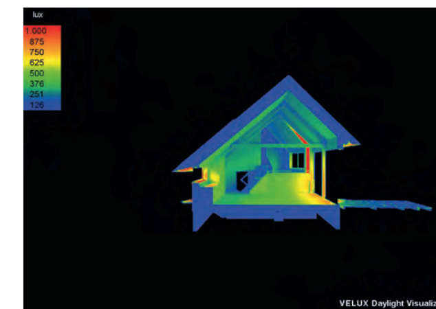
Daglichttoetreding via de noordgevel van het dijkhuis in maart om 12:00 uur.
